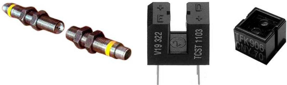
Рисунок 7 - Примеры оптоэлектронных сенсоров. Слева - с отдельным передатчиком и приемником, в центре - излучатель и приемник в одном корпусе, справа - воспринимающие отраженное от объекта излучение.
